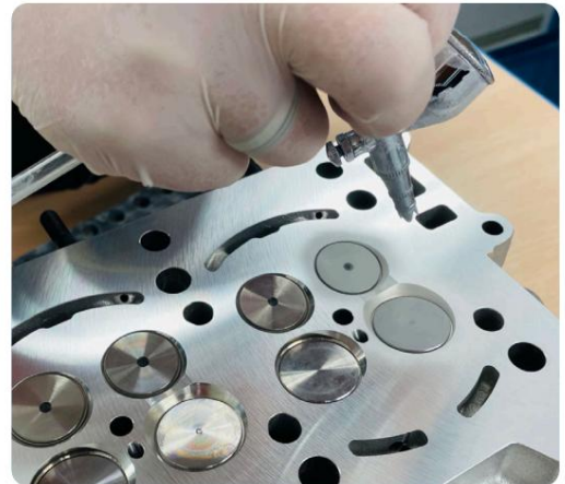
Aura por aerógrafo para máxima precisión
